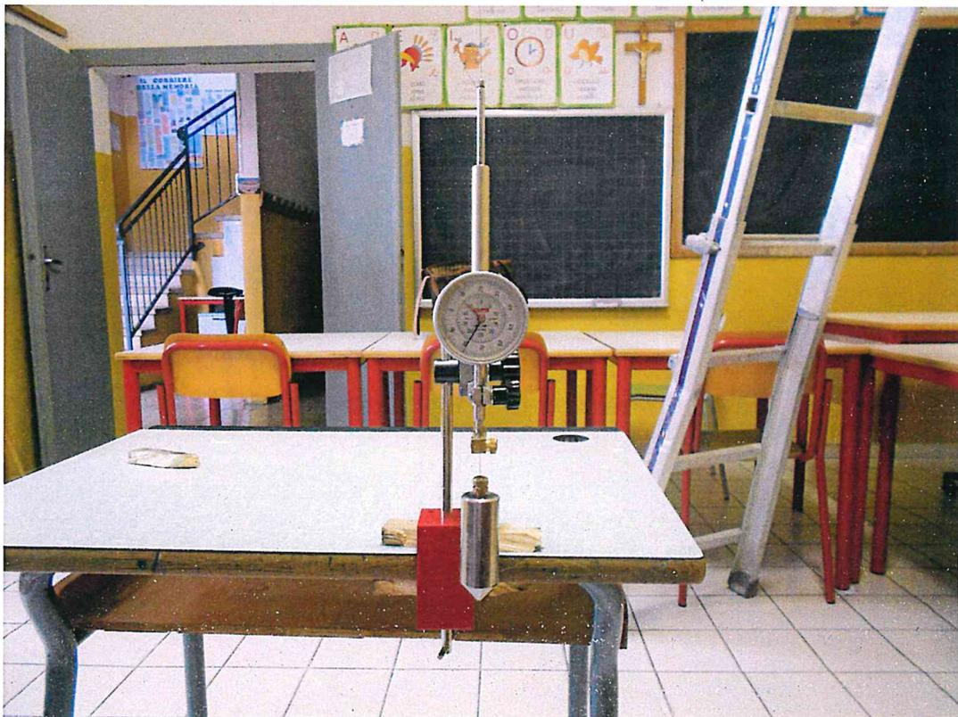
E' stata caricata una striscia di solaio pari a 1,30 x 4,80 metri, mediante la stesa di 125 sacchi di sabbia con peso unitario pari a 25 daN su cinque strati.
